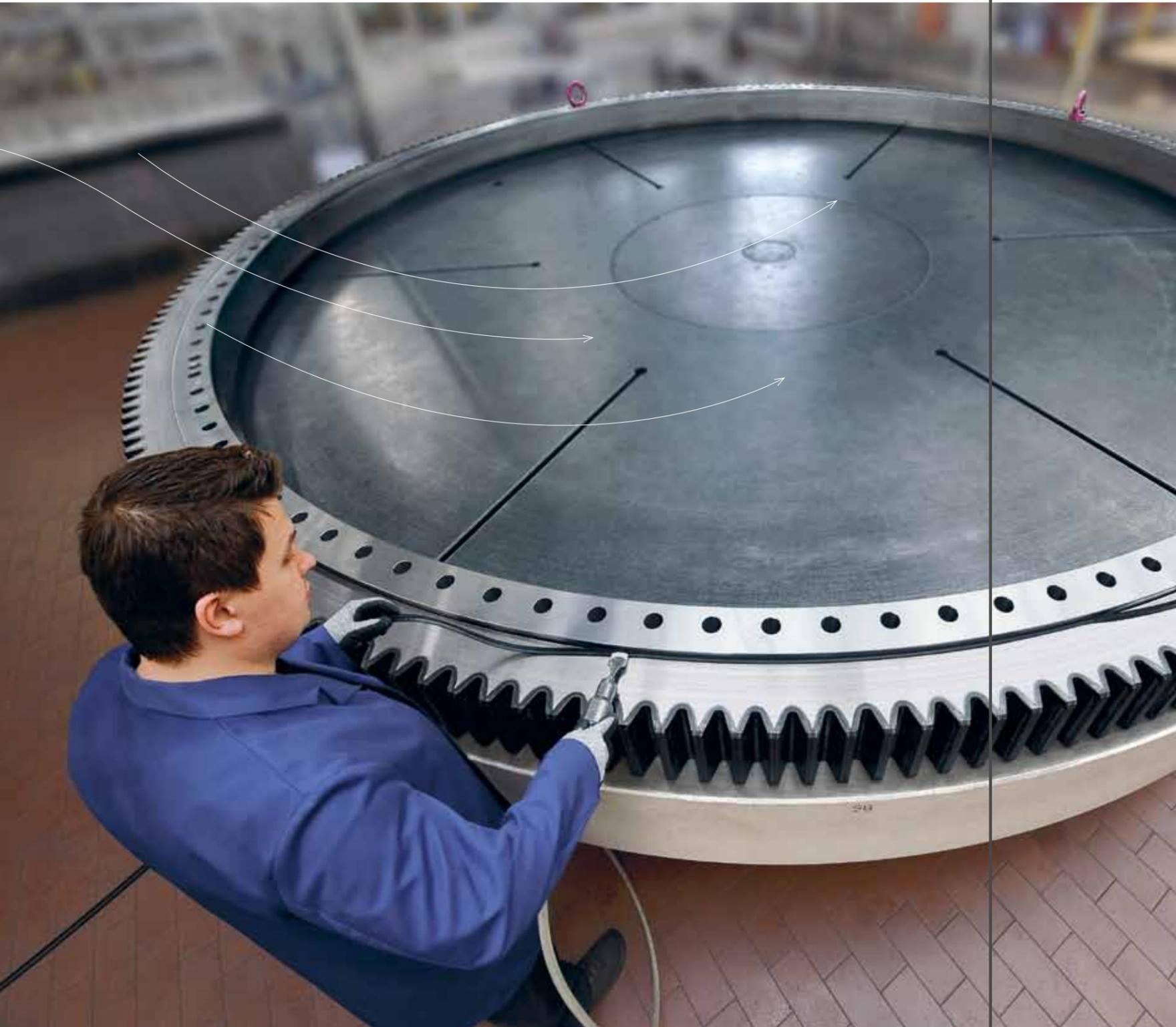
Dank dieser intensiven Forschungsarbeit sind Rothe Erde® Großwälzlager in Windenergieanlagen auf der ganzen Welt erfolgreich im Einsatz. Auch bei nahtlos gewalzten Ringen aus Stahl und NE-Metallen nehmen wir eine führende Position ein.
